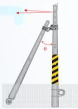
193. (2) 下圖架空光纜佈放之仰角急劇變化，請問 $\beta$ 角有可能是幾度？① $4^\circ$ ② $10^\circ$ ③ $12^\circ$ ④ $15^\circ$ 。
